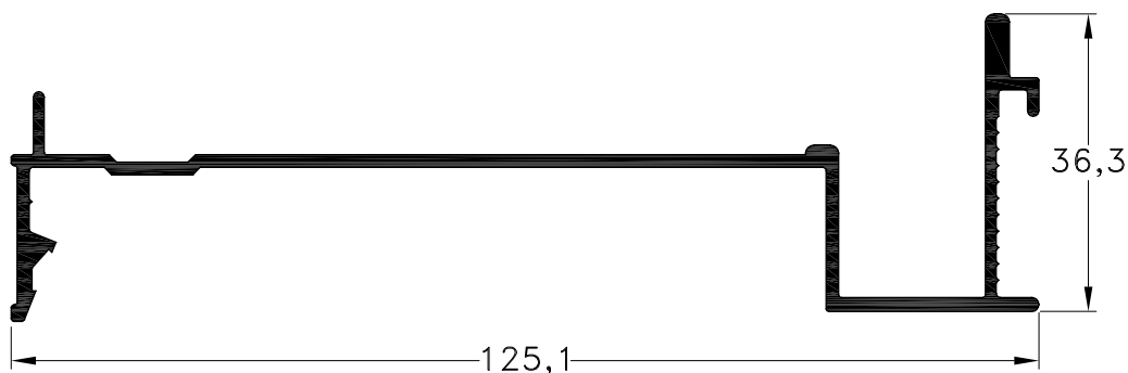
1010008 - Guía Cortina Regulable Peso: 0,93 Kg/m. Largo Std.: 6.200 mm.
